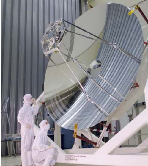
Εικόνα 3. Φωτογραφία του κατόπτρου του Διαστημικού Τηλεσκοπίου Herschel (διαμέτρου 3.5 μέτρων) κατά την διαδικασία κατασκευής του στα εργαστήρια του Ε.Ο.Δ. © ESA, 2007.
