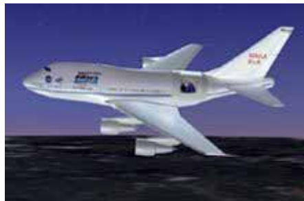
Εικόνα 2. Το διαστημικό τηλεσκόπιο SIRTIF της NASA το οποίο εκτοξεύθηκε στις 25 Αυγούστου 2003 (αριστερά) και το SOFIA, ένα ειδικά διαμορφωμένο BOEING 747 το οποίο με τη χρήση ενός τηλεσκοπίου θα πραγματοποιεί παρατηρήσεις στο υπέρυθρο (δεξιά). Δες άρθρο "SIRTIF - Ένα δορυφορικό μάτι που βλέπει μέσα από την σκόνη" στα Σύγχρονα Θέματα του περιοδικού μας.
